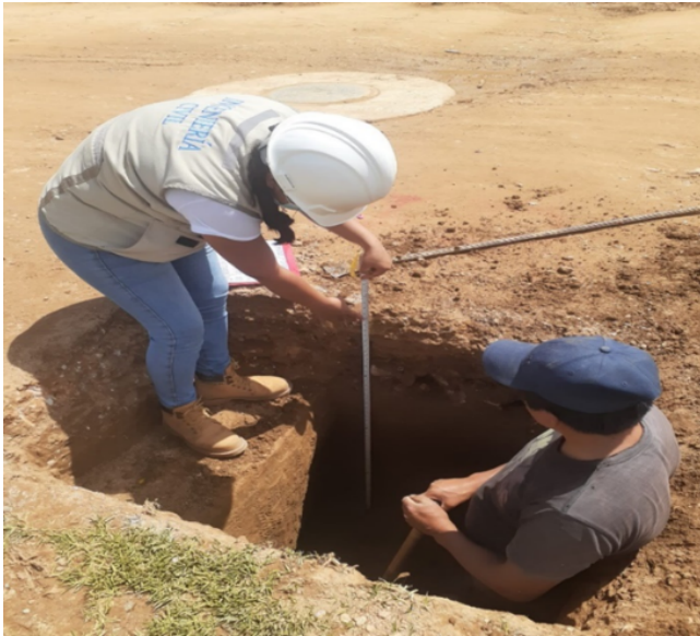
Figura 2. Extracción de muestra de suelo (Fase II)
