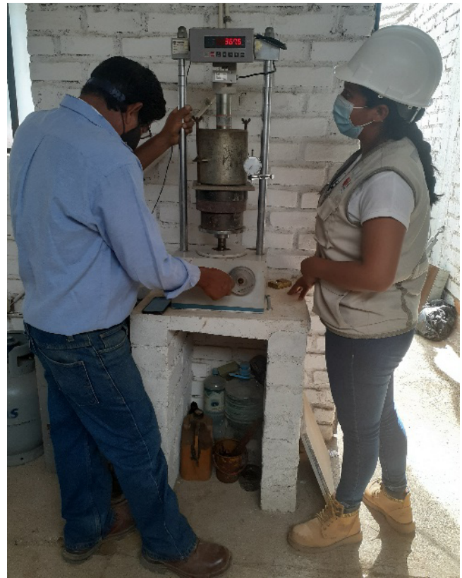
Figura 4. Ensayo del Valor de soporte de California (CBR) del suelo cohesivo con la vinaza (Fase II)
