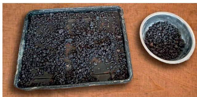
Figura 2. Cuarteo de escoria de acero para su correcta granulometría
