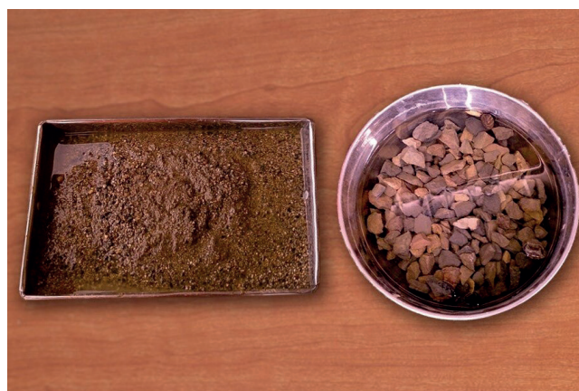
Figura 1. Lavado de agregados para su correcta granulometría
