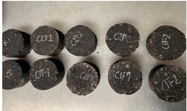
Figura 3. Probetas después del curado C de 14 días a 40 °C
