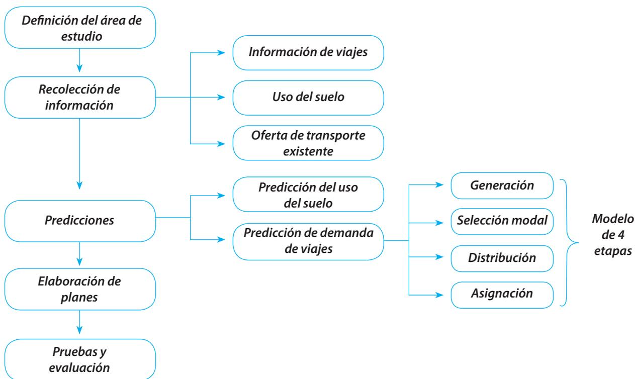
Figura 2. Esquema general del procedimiento aplicado en CATS
