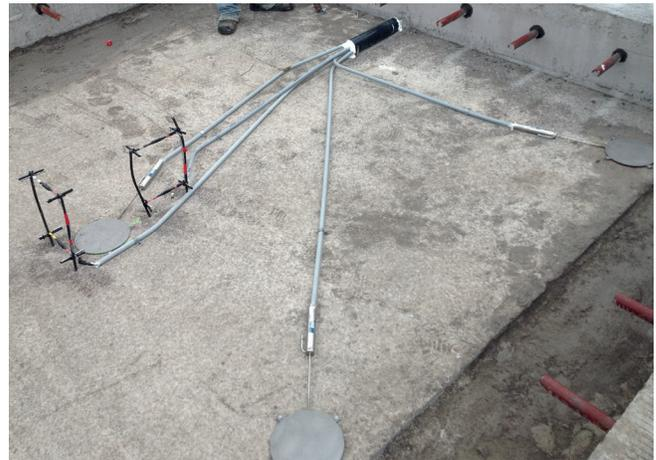
Figura 5. Instrumentación del pavimento rígido del AIJS (LanammeUCR, 2015)
