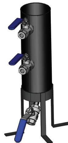
Figura 4. Tanque de almacenamiento de asfalto a escala para estudio de separación
